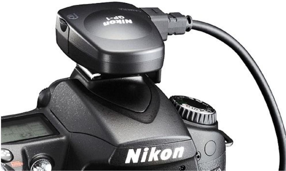
Parmi les solutions du marché, il y a la solution Nikon et le module **GPS Nikon GP-1**. Ce module inscrit les données de positionnement telles que la latitude, la longitude, l'altitude et l'heure sous forme de 'balises géodésiques' dans les données EXIF de chaque image. Solution luxueuse puisque vendue couramment 200 euros et plus, le GP-1 est une solution fiable.
