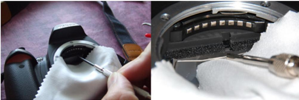
Le tournevis est posé sur le rebord du boîtier. Le plat du tournevis est perpendiculaire au cadre.
