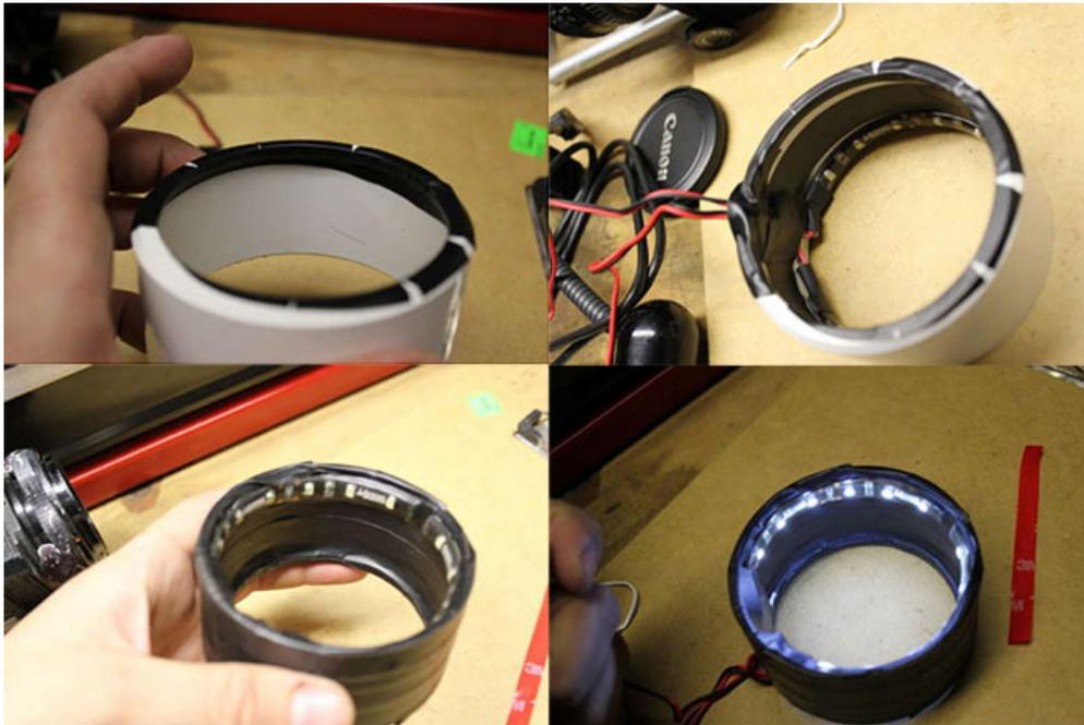
Un peu trop réfléchissant en blanc, le tuyau PVC est recouvert de ruban adhésif noir. Les LED sont positionnées avant application de l'adhésif à l'emplacement requis. Il est recommandé de tester l'éclairage dès cette étape pour s'assurer que rien n'est endommagé.
