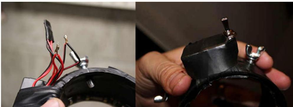
Procurez-vous une petite boîte en plastique et positionnez l'interrupteur de façon à ce que seul le bouton de commande soit apparent.
