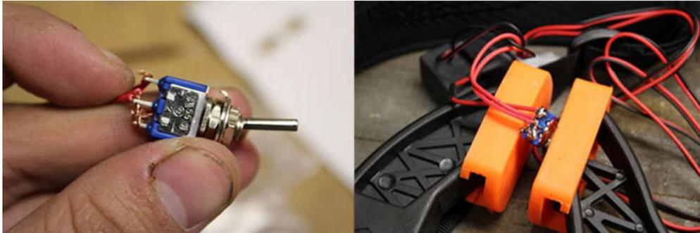
Le flash sera commandé par un mini-interrupteur que l'on trouve chez les revendeurs de composants électroniques. Retirez le bouton d'origine s'il est livré avec les LED et soudez à la place un interrupteur miniature.
