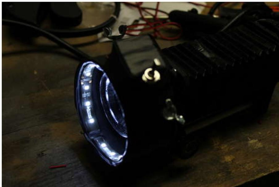
*fabriquer un flash annulaire : test de l'éclairage une fois le flash terminé*
