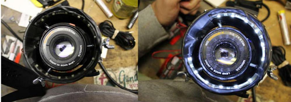
Percez trois trous dans la bague PVC, en triangle, de façon à permettre un positionnement correct sur l'objectif. Assurez-vous que le flash ne sera ni trop loin du bord, ni trop près pour pouvoir serrer sans endommager le pourtour de l'optique.
