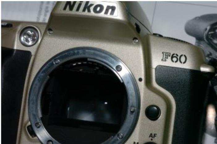
Ici le Nikon F 60, sans index AI, le pilotage de l'ouverture se fait de façon électrique par plots. La mesure de lumière n'est pas possible avec les objectifs AI et AIS. Notez qu'il s'agit de la même monture que le Nikon F401 sorti dix ans plus tôt.
