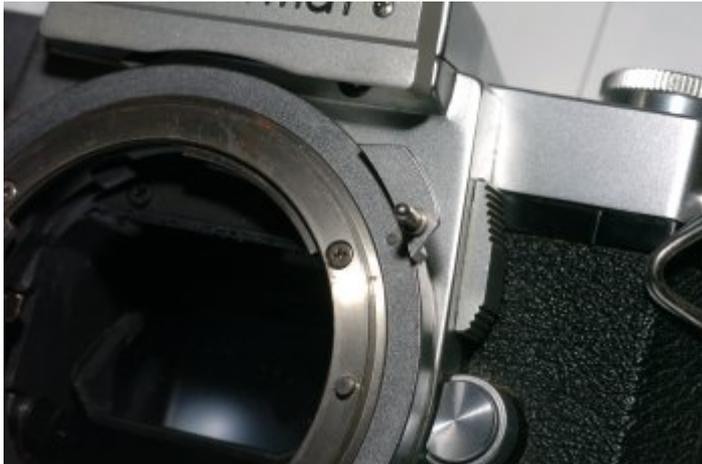
Le boîtier (ici un Nikkormat) dispose d'un système d'index actionné par la fourchette de l'objectif.
