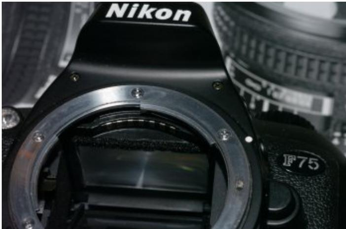
Ici un Nikon F75, la monture F est identique aux autres reflex Nikon, sans index AI. Le pilotage de l'ouverture est électronique par plots mais le couplage de l'autofocus AF-S et VR (réduction de vibration) est assuré.
