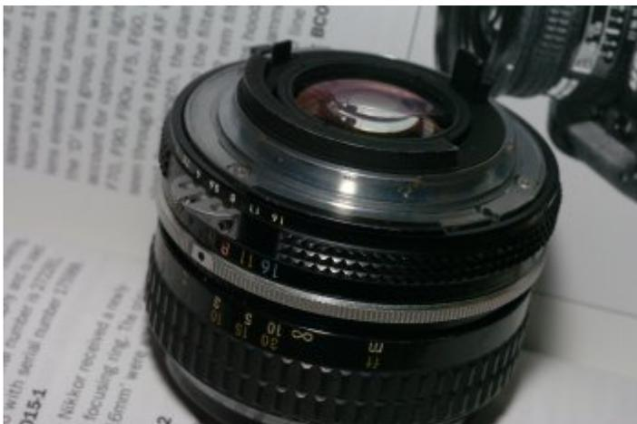
Les objectifs de la série Ai disposent d'une fourchette ajourée, d'une seconde graduation du diaphragme et d'une bague de couplage AI compatible à la fois avec les boîtiers à fourchette et les boîtiers à index AI.
