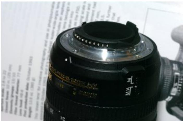
Sur les objectifs NIKKOR AFS-G la bague de diaphragme disparaît, les contacts électriques assurent le pilotage de l'autofocus et de l'exposition.
