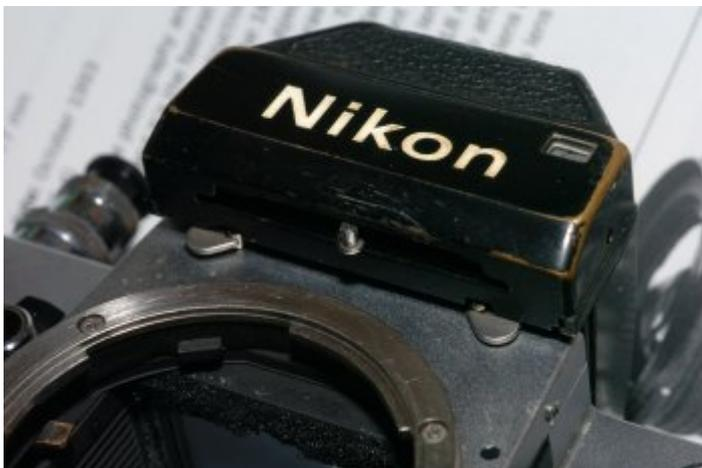
Ici, avec un Nikon F2 de la génération « non Ai », l'index de couplage est replié dans le prisme avant montage de l'optique.
