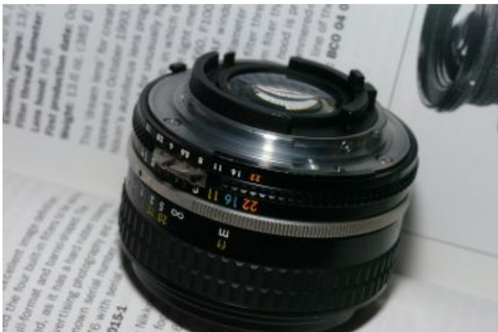
Sur cet objectif Nikon AIS d'origine, l'indication d'ouverture la plus faible sur la petite échelle est peinte en orange. La cuvette dans la monture arrière sert au couplage FA, elle est inutile sur un reflex numérique.
