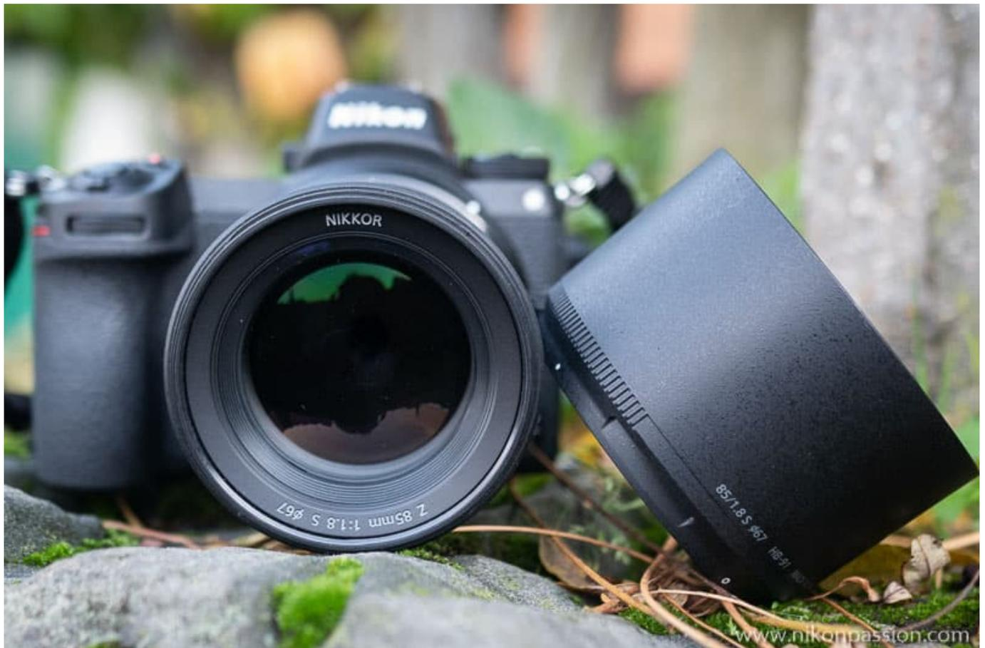
Plus proche de nous, sur un objectif en monture Z on peut lire Z 85 mm 1:1,8 S Ø67 : ceci indique que nous sommes en présence d'un 85 mm ouvrant à f/1,8, que cet objectif est en monture Z pour hybrides, qu'il appartient à la série S (Supérieur) et que le diamètre de filtre est de 67 mm.
