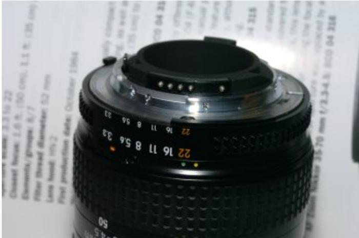
Cet objectif Nikon AF d'origine est contemporain du Nikon F401. Il ne dispose plus de la fourchette des précédentes séries, mais propose une monture Nikon AIS complète (bague et cuvette) permettant l'usage sur les Nikon FE2 et FA par exemple.
