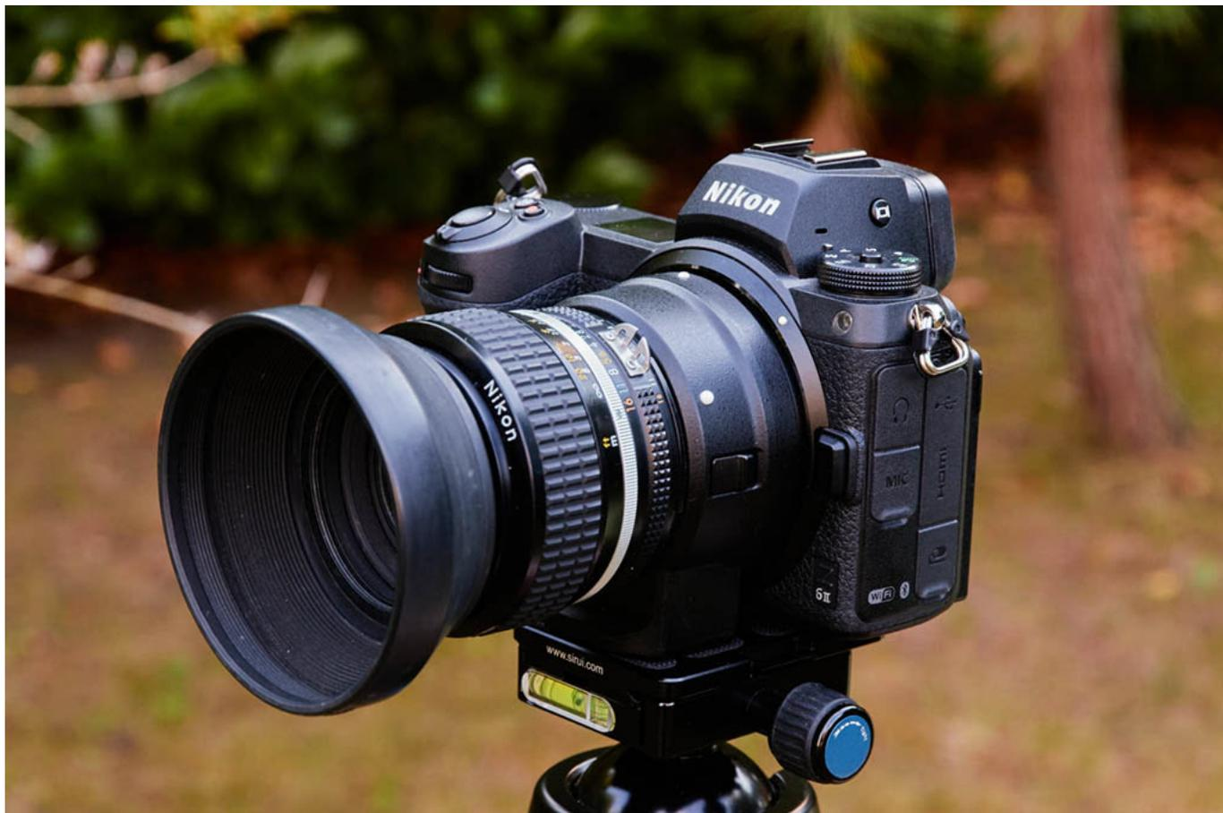
*le NIKKOR 50/1,2 Ais monté sur le Nikon Z 6II via la bague FTZ forme un ensemble aux proportions encore acceptables. Reste à réussir des images nettes à grande ouverture !*
