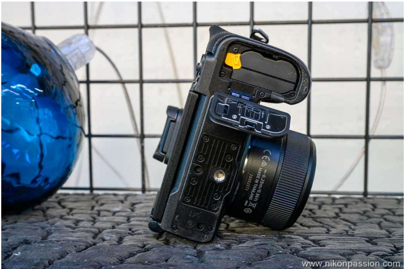
Nikon Z5II - trappe batterie Nikon EN-EL15c
