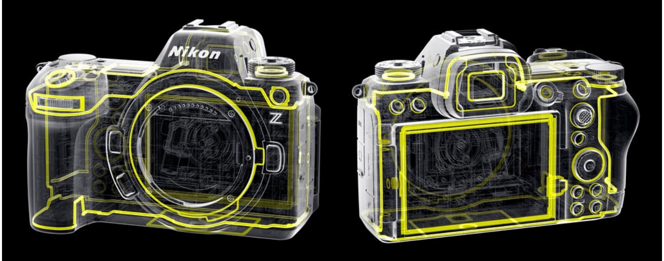
La protection par joints toriques du Nikon Z6III
