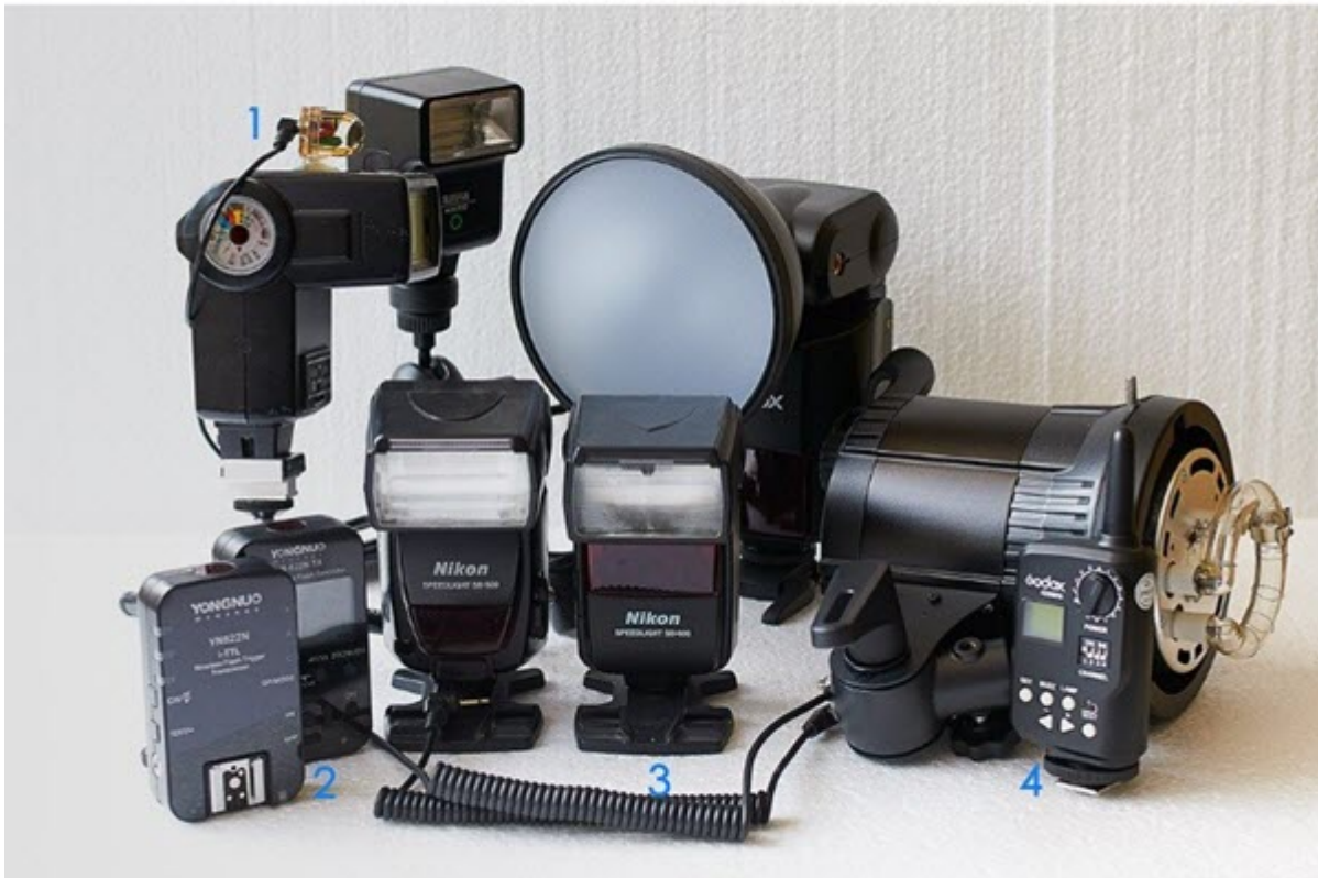
Cellule photosensible (1), déclencheurs radio (2) et (4) et câbles de connexion (3)
