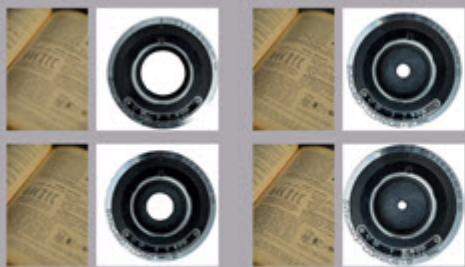
Figure 2.1 Evolution de la profondeur de champ en fonction de l'ouverture de diaphragme
