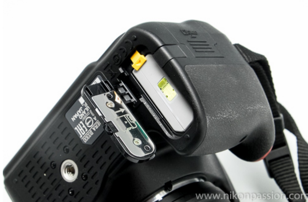
La batterie dans son logement sous le boîtier
