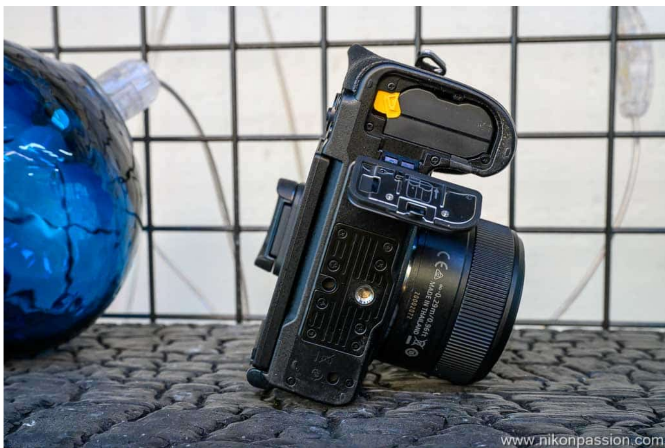
Nikon Z5II - trappe batterie Nikon EN-EL15c
