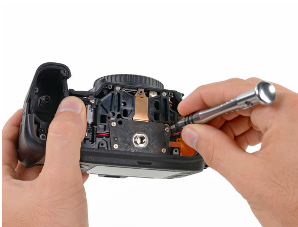
Démontage de la semelle du boîtier du Nikon D600
