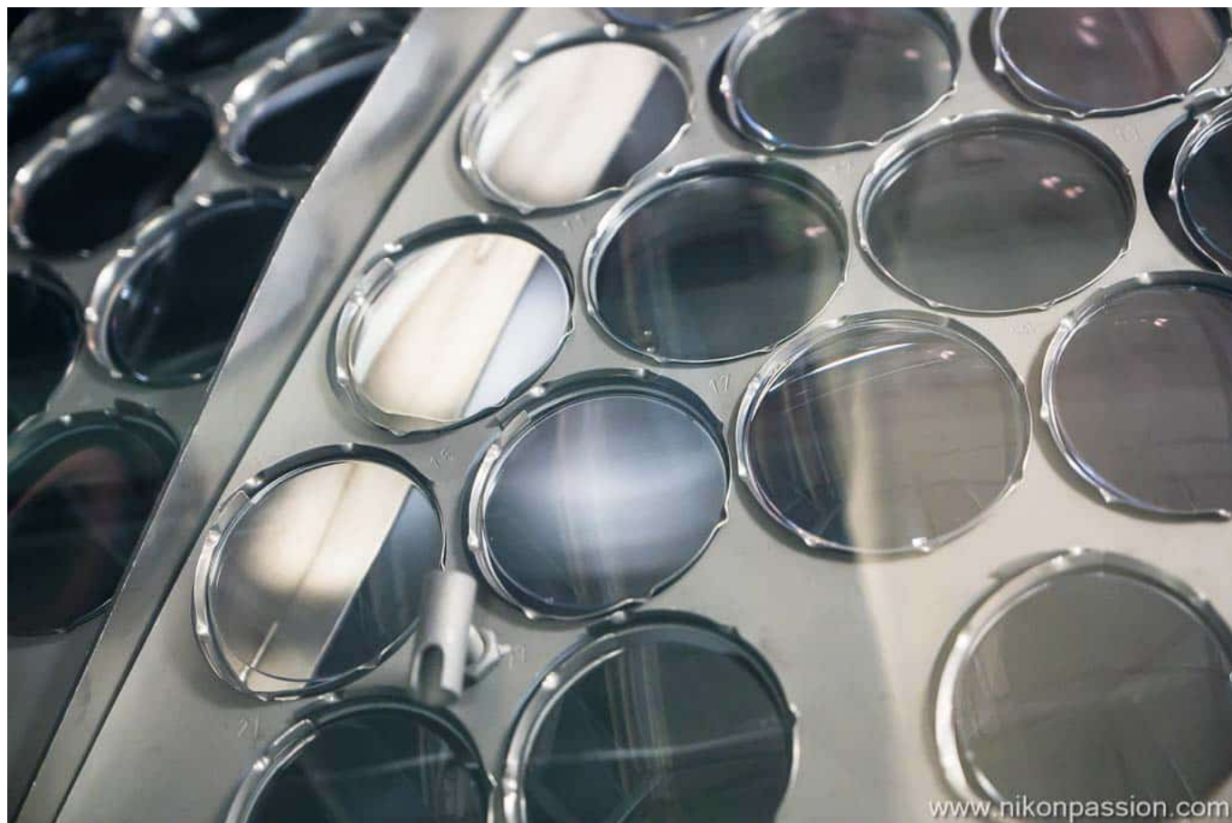
l'application des nombreuses couches de revêtements de surface
