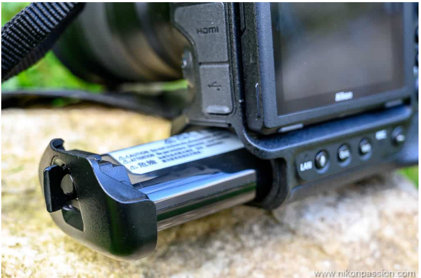
Nikon Z 9 : trappe batterie Nikon EN-EL 18d avec verrouillage
