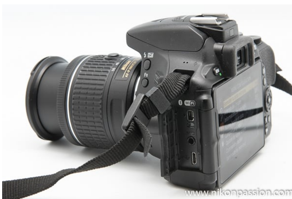
Test Nikon D5600 : vue de profil, entrées sorties audio et vidéo et prise USB
