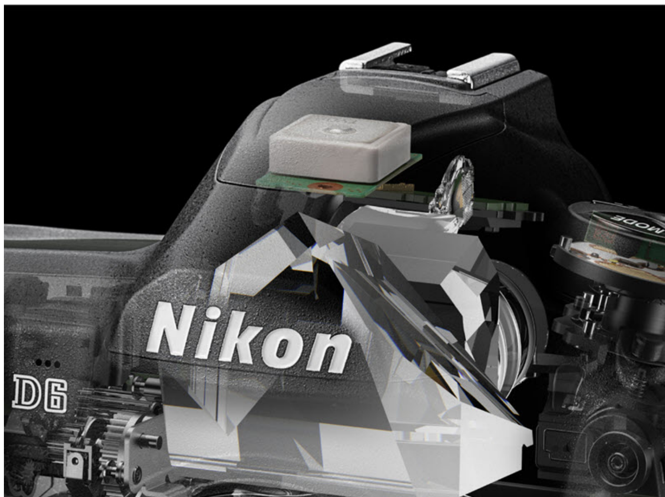
le module GPS intégré du Nikon D6
