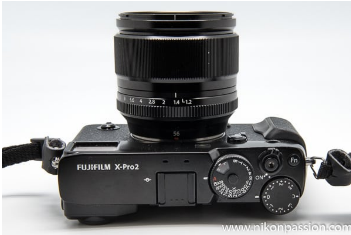
Le Fujifilm X-Pro2 vu de dessus avec ses 2 couronnes, la molette avant et le levier de sélection du type de visée
