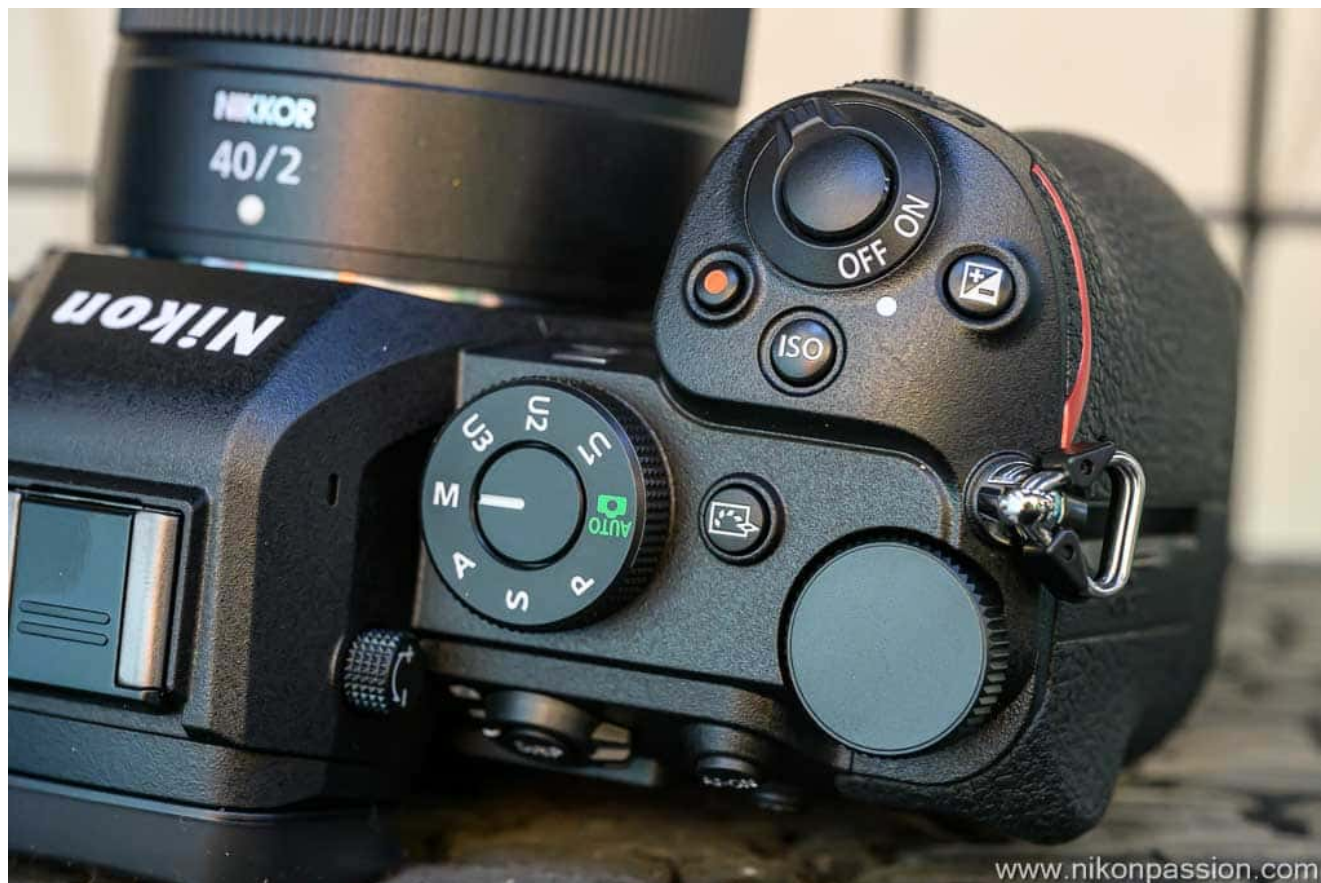
Nikon Z5II - commandes supérieures avec touche d'accès aux Picture Control
