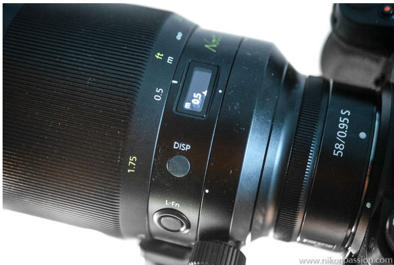
Test Noct-NIKKOR Z 58 mm f/0,95 S : l'écran OLED et la touche de fonction personnalisable
