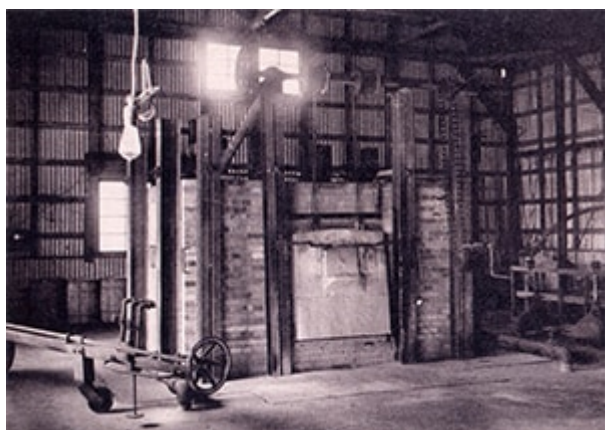
Four de fusion de 500 kg pour la fabrication des optiques Nikon - Photo (C) Nikon Corp.
