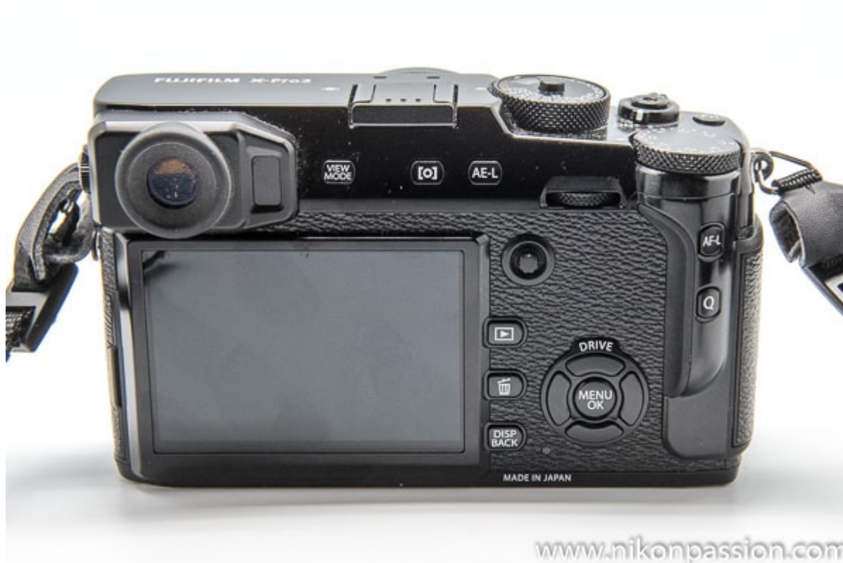
Face arrière du Fujifilm X-Pro2 avec l'ensemble des touches déportées à droite
