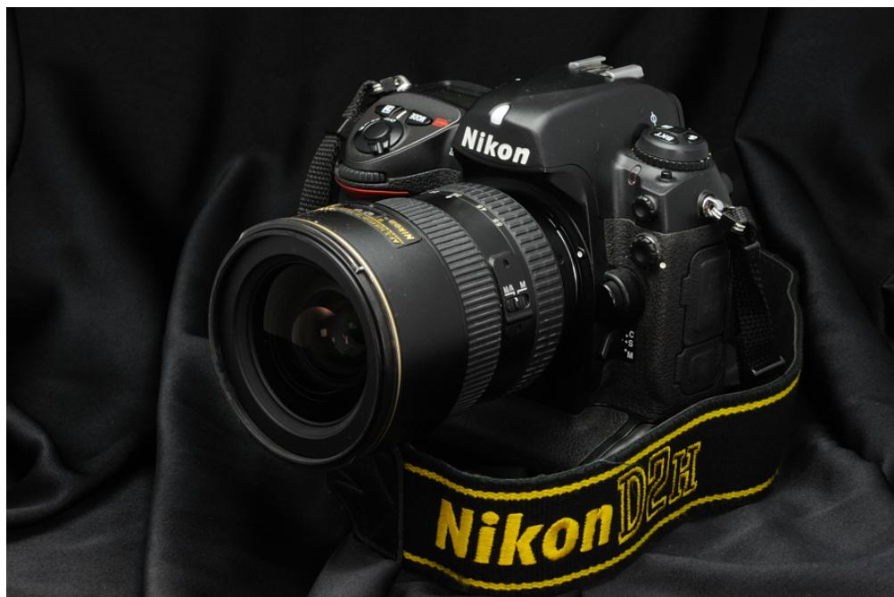
En 2003 Nikon remplace la gamme D1 par le **Nikon D2H**. Ce dernier propose 4,1Mp, 8im./sec., un capteur de lumière ambiante, un obturateur conçu pour supporter 150.000 cycles. Cet obturateur permet une vitesse de 1/8000sec. en régression par rapport au D1 mais l'électronique est toute autre : le module AF CAM-2000 et ses 11 collimateurs font merveille.
