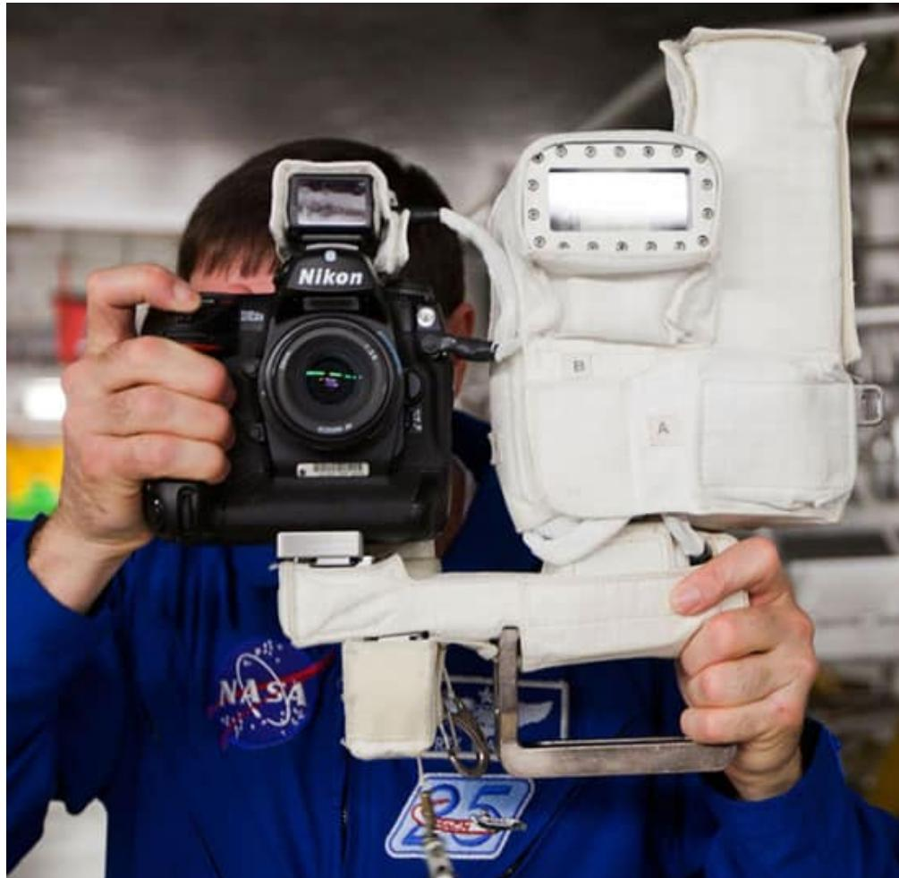
Les modifications apportées au [D2Xs](#) consistait à permettre l'utilisation simple par les photographes du bord. En particulier il s'agissait de permettre le bon fonctionnement du flash SB-800 qui se cache sous le sac thermique blanc. Le flash ne peut fonctionner correctement dans le vide spatial lors des sorties aussi la modification permet-elle de conserver de l'air autour du flash. Il en est de même du support qui tient le flash au boîtier et assure également l'étanchéité.
