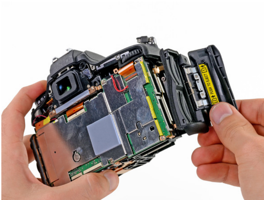
Démontage des éléments latéraux et du boîtier du Nikon D600
