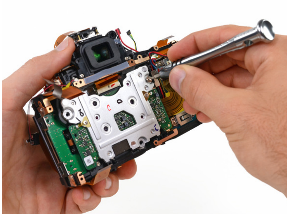
Démontage de la face arrière du Nikon D600 après retrait de l'écran LCD
