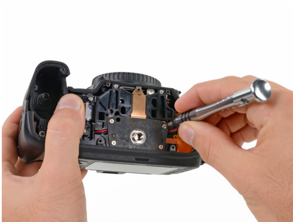
Démontage de la semelle du boîtier du Nikon D600
