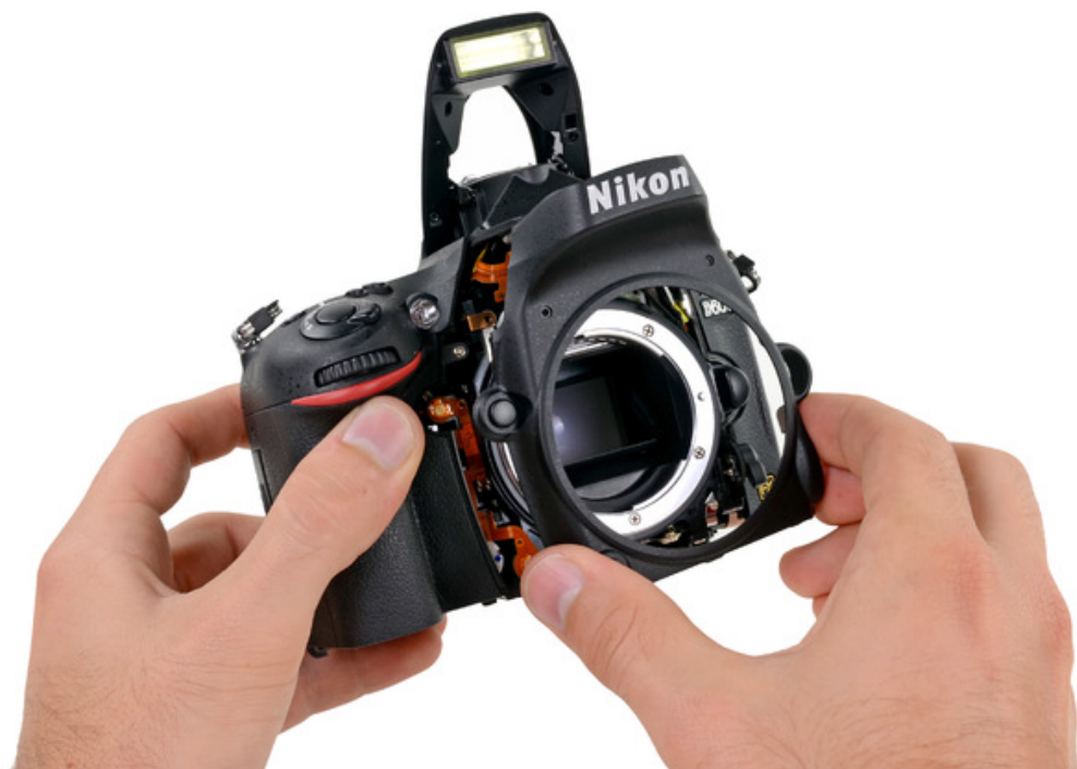
Démontage de la face avant du Nikon D600
