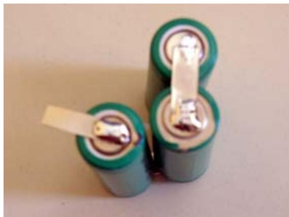
L'assemblage à trois. L'électrode de l'élément de gauche sera reliée au fil rouge.
