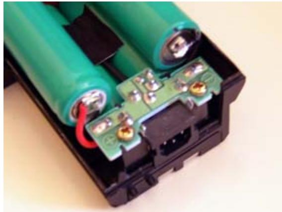
Placer le pack dans la coque et souder les fils d'alimentation.
