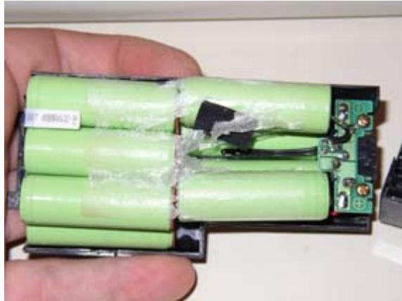
On aperçoit à gauche, en blanc, le fusible et au fond en noir, le capteur de température. Première remarque, les éléments ne sont pas de taille répandue : il s'agit d'un format 3/4 AA (43x17mm) difficile à trouver. J'ai dû en acheter un lot de 60 sur ebay. Pas grave, l'économie est toujours au rendez vous.
