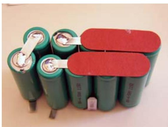
Maintenant, il va falloir retirer les anciens éléments du MN-30 pour récupérer les cartons isolants et les recoller sur notre nouveau pack. ATTENTION !!! lors de l'extraction des anciens éléments, il y a risque de court-circuit, d'échauffement et donc de réelle brûlure !!
