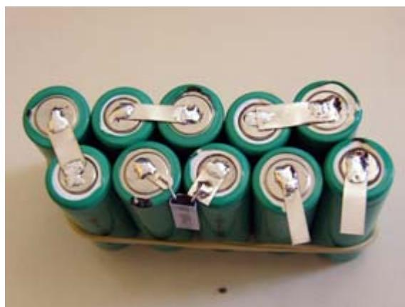
Et nous voici avec nos 10 éléments. L'électrode négative est maintenant soudée sur le deuxième élément de la ligne du bas (en partant de la droite)
