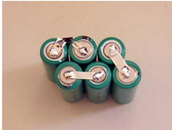
J'ai réalisé 3 blocs de 2 éléments que j'ai rassemblé et soudé. Attention encore à la polarité. En photo la face nord. Prendre le fusible comme repère.
