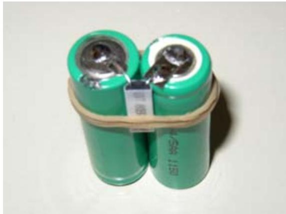
Début de la construction du nouveau pack. Je commence par les éléments soudés au fusible. J'ai utilisé un feuillard de nickel souple pour réaliser les électrodes qui me permettent de relier les éléments. Attention à la polarité, une inversion et rien
