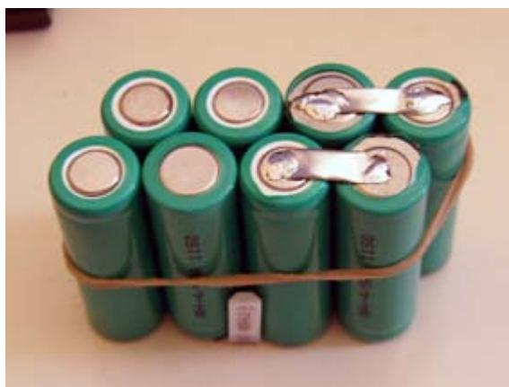
Assemblage réalisé pour pouvoir positionner et souder l'élément de gauche de la ligne du bas avec son voisin de droite. Après soudure, nous aurons donc 3 électrodes horizontales : une en haut à droite et 2 en bas. L'élément en haut à gauche ne sert qu'à caler l'ensemble, il sera retiré en suite pour faire l'assemblage qui suit.
