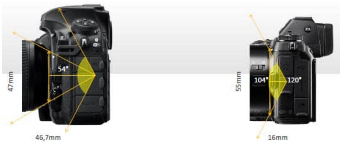
cônes utiles émergents des optiques Nikkor F à gauche vs. les optiques Nikkor Z à droite
