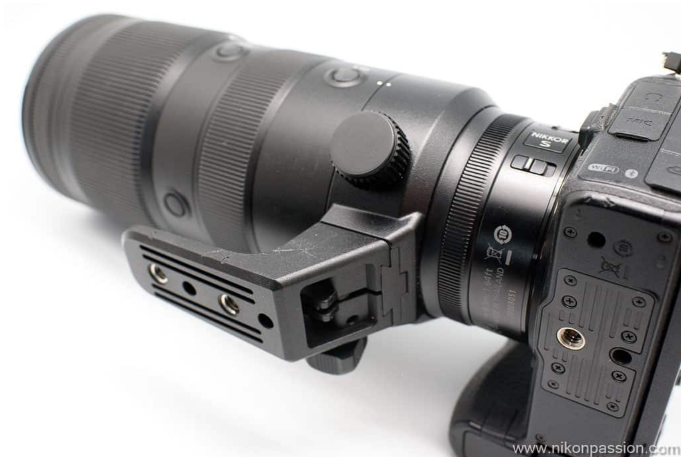
Collier de pied démontable du NIKKOR Z 70-200 mm f/2.8 VR S Notez les touches L-Fn2 entre les deux bagues
