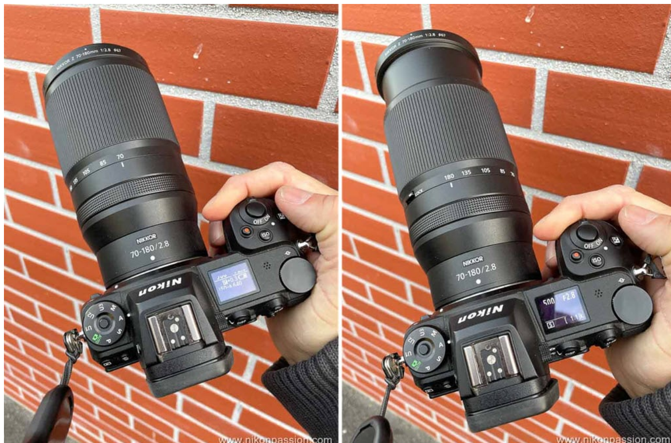
Test NIKKOR Z 70-180 mm f/2.8 : 70 mm à gauche - 180 mm à droite le loquet de verrouillage est visible sur la photo de droite
