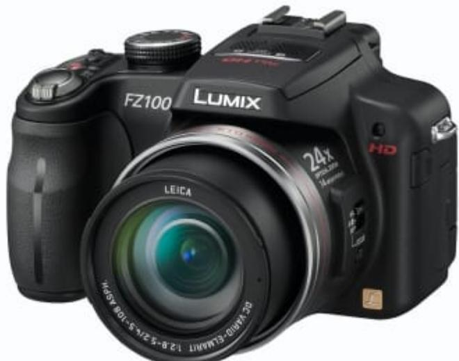
Le **Lumix FZ-100** est un bridge équipé d'un capteur MOS 14 MPixels, d'un zoom optique x24, d'une optique non interchangeable ultra grand angle 25mm, avec un mode vidéo Full HD 1080i et un large écran 3" orientable.
