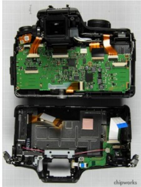
Ces vues éclatées permettent de voir que le **Lumix GH2** embarque un capteur MN34070 fabriqué par Panasonic, avec 16 Mp.
