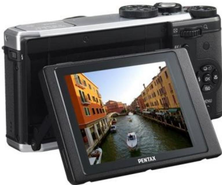
Le MX-1 propose un écran arrière LCD de 3 pouces de diagonale soit 7,5 cm, de 920.000 points de définition. Cet écran est inclinable et Pentax revendique une
