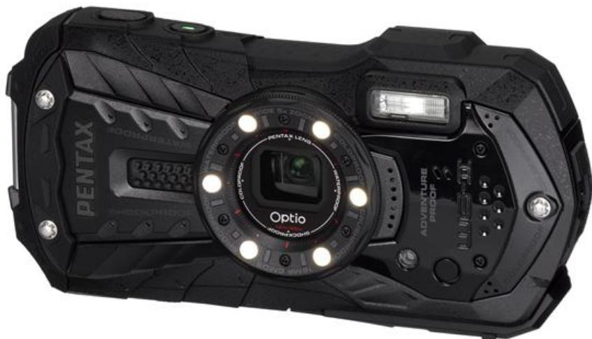
Les Optio WG2 et WG2-GPS sont équipés d'un nouveau capteur rétro-éclairé de 16 Mégapixels et d'un zoom optique 5 x grand-angle périscopique (équivalent 28-140mm en 35mm) comportant 11 éléments en 9 groupes. La sensibilité annoncée par Pentax s'étend de 125 à 6400 ISO. Le capteur est stabilisé pour les vitesses lentes.
