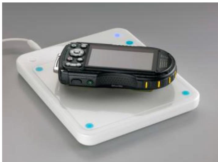
Le Pentax WG-3 GPS (uniquement cette version curieusement) dispose d'un système de recharge des batteries « QI sans fil » (Puissance à Induction). Ce système permet de recharger automatiquement les batteries en plaçant simplement l'appareil sur la station de recharge QI. Plus besoin de jouer avec les câbles, d'ouvrir la trappe batterie et de laisser rentrer des impuretés ou de l'eau. Il est tout de même dommage que la version sans GPS ne bénéficie pas de ce système.
