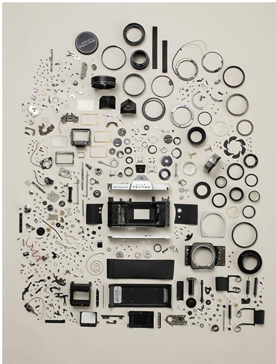
Voici une deuxième vue de ce Pentax entièrement démonté, les pièces et
