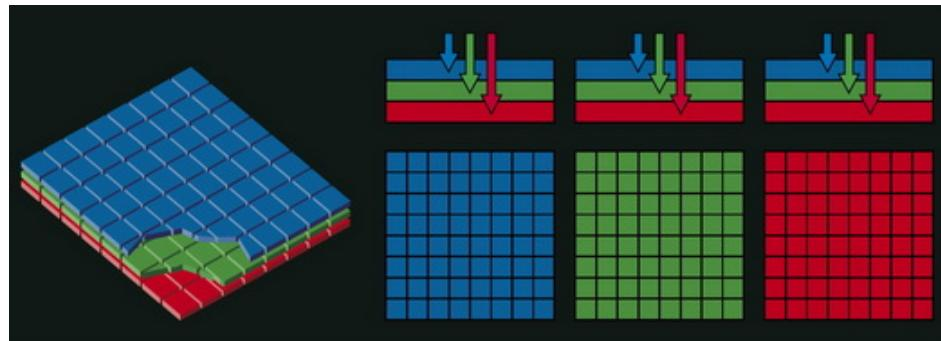
Principe de fonctionnement du capteur Foveon avec ses 3 couches sensibles
