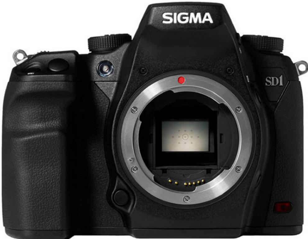
Le Sigma SD1 a un boîtier en magnésium, un écran LCD 3 pouces, un viseur optique 98%, il fait l'impasse sur la vidéo et marque le pas sur la concurrence
