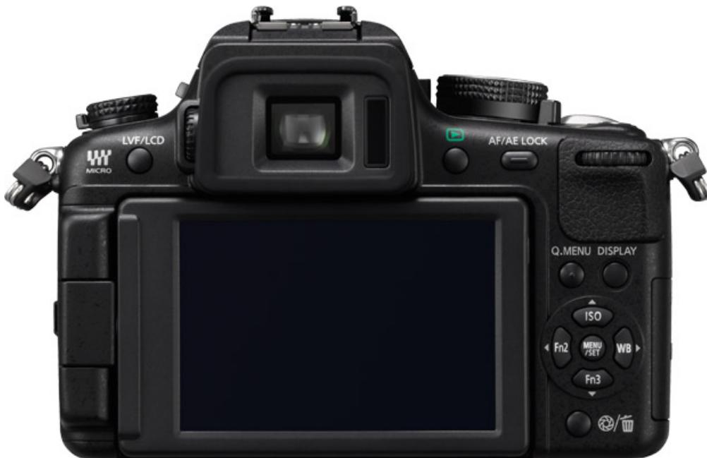
Le **Lumix GH2** dispose d'un viseur 100% avec un grossissement de 0,71x, ce viseur reste bien évidemment de technologie LCD et nous avons trouvé la visée plutôt claire et agréable, une bonne surprise là-aussi quand on est fan des viseurs optiques. Les reflex n'ont qu'à bien se tenir ! Rappelons que le GH2 permet la visée sur l'écran LCD arrière ou à travers le viseur comme sur un reflex. Un commutateur permet de passer facilement d'un mode à l'autre.
