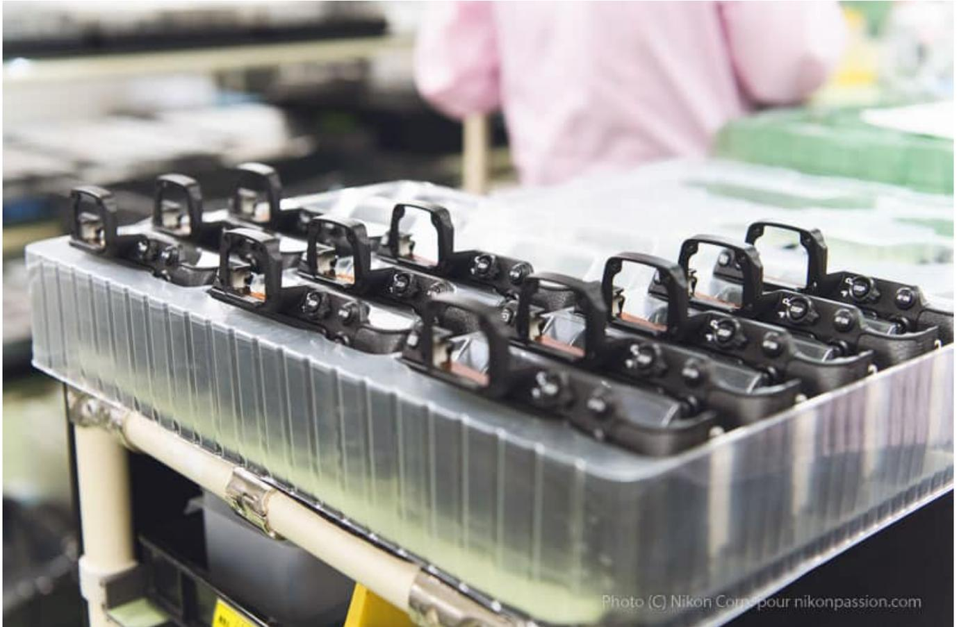
Plusieurs autres opérations d'assemblage ont lieu à la suite, comme la fixation de l'ensemble obturateur. Celui-ci subit une batterie de tests automatisés dès son montage afin de détecter très vite tout problème.
