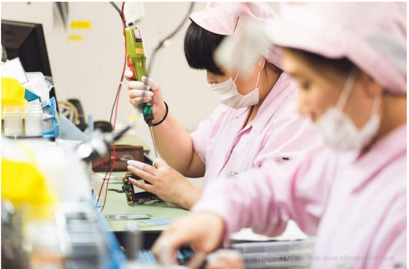
En début de chaîne plusieurs opérateurs assemblent les différentes parties du boîtier telles que le châssis, la face avant, la monture, le tout à l'aide d'un outillage spécialisé et de tournevis électriques permettant d'assurer un positionnement précis et un vissage aux normes des différents composants.
