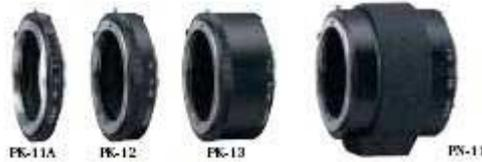
Les bagues allonges sont également connues sous le nom de tubes allonges. Ces bagues sont généralement en métal ; elles s'intercalent entre le boîtier et l'objectif. On augmente ainsi la distance entre le support (film ou capteur) et l'objectif sans trop de déformation et d'aberration optique. On réduit ainsi la distance de mise au point.
