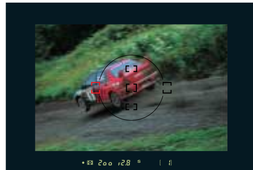
Dynamique AF: L'appareil continue de mettre au point sur le sujet en changeant automatiquement de zone de mise au point si celui-ci sort de celle sélectionnée.
