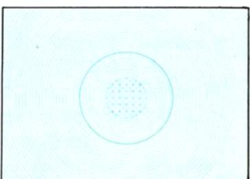
**Type J** Réseau Fresnel avec plage centrale de mise au point ultra lumineuse à micro-prismes. Cercle gravé de 12mm de diamètre. Mise au point facile. Couvre la plupart des besoins.
