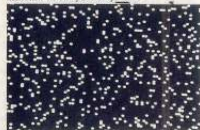
Microphotographie du miroir, montrant la disposition aléatoire des perforations.
