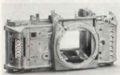
Le boîtier en fonte d'aluminium, montrant l'accès aux potentiomètres de réglage.
