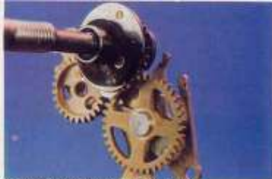
Le mécanisme d'armement tourne sur roulement à billes.
