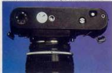
Vue du dessous : noter les plots de couplage au moteur.
