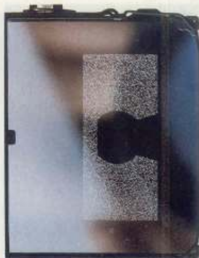
Le miroir de visée : les perforations sont nettement visibles par transparence.
