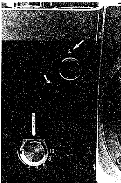
Levier rotatif de remontée manuelle du miroir après rotation de 135° environ dans le sens inverse des aiguilles d'une montre.
