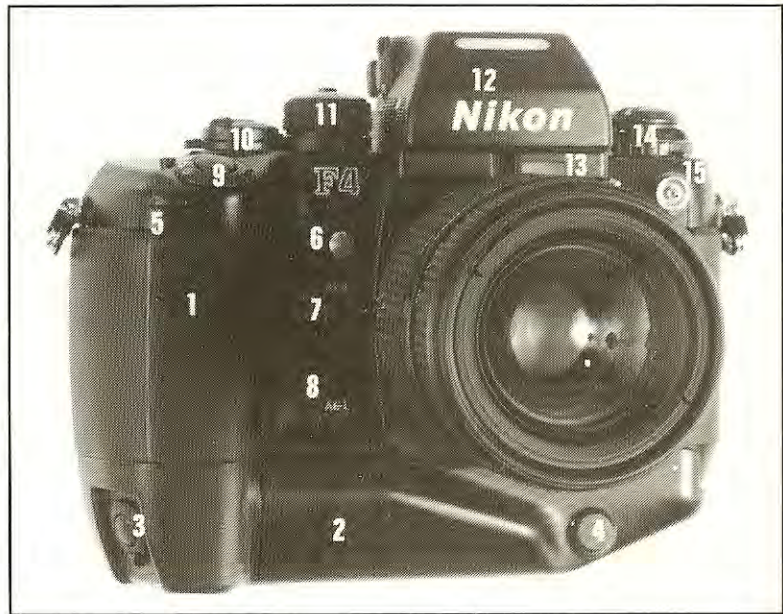
Nikon F4S vu de face, muni de son viseur standard multimesure DP-20 : 1. Poignée du générateur MB-21 contenant trois piles. -2. Semelle du générateur MB-21 contenant trois piles. -3. Déclencheur latéral verrouillable pour faciliter la tenue de l'appareil en cadrage vertical. -4. Prise de télécommande électrique (ici masquée par son bouchon protecteur à vis). -5. DEL du retardateur (est-ce bien raisonnable, sur un appareil pro doté de telles possibilités de commande à distance ?). -6. Commandes de test de profondeur de champ et de relevage manuel du miroir. -7. Touche de mise en mémoire de la mise au point, et levier permettant de coupler la mémorisation de la mise au point avec celle de l'exposition. -8. Touche de mise en mémoire de l'exposition. -9. Déclencheur, entouré par la couronne du sélecteur de cadence d'armement. -10. Correcteur d'exposition. -11. Barillet des vitesses. -12. Viseur multi-mesure DP-20, livré en standard avec le F4/F4S. -13. Fenêtre d'illumination de l'échelle des ouvertures de l'objectif, pour permettre sa lecture dans le renvoi optique du viseur. -14. Manivelle de rembobinage et couronne d'affichage de sensibilité. -15. Prise synchro X coaxiale standard, à couronne vissante pour les câbles Nikon.
