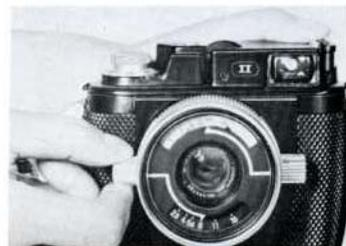
Afficher la vitesse d'obturation. Régler le diaphragme en tournant le bouton correspondant. Effectuer la mise au point en tournant le bouton de mise au point.
