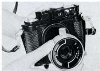
Présenter l'objectif sur le boîtier, le bouton de mise au point orienté vers le haut. Le verrouiller par une rotation de 90° dans le sens des aiguilles d'une montre, et repousser la couronne du barillet vers le boîtier, par une légère pression.
