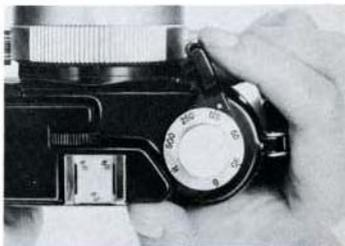
Le déclenchement de l'obturateur est effectué par une nouvelle pression sur le levier d'armement, vers le boîtier.
