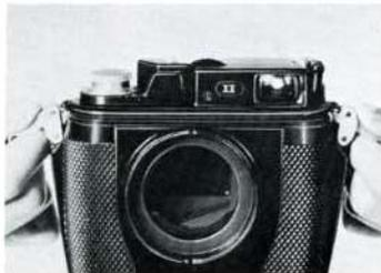
Soulever la plaque du presse-film. Mettre la cartouche de film en place. Introduire l'extrémité de l'amorce dans la bobine réceptrice. Rabaissier alors la plaque du presse-film.
