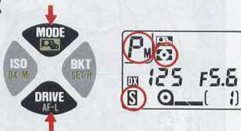
Pressez simultanément sur deux commandes au choix (MODE, ISO, DRIVE et BKT) pendant plusieurs secondes jusqu'à ce que **P**, **M** et **S** s'affichent sur l'écran de contrôle (simultanément, P apparaît dans le viseur), ce qui indique que les réglages de l'appareil sont automatiquement réinitialisés pour une prise de vue élémentaire qui s'opère comme suit:
