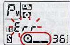
L'entraînement du film casse automatiquement en fin de film, **End** et **Q** clignotent sur l'écran de contrôle. Puis, l'indicateur d'exposition s'allume automatiquement, alors, chaque fois que vous pressez le déclencheur, **Err** clignote et **Q** apparaît à la place sur l'écran de contrôle pour vous signaler que vous devez rebobiner le film.
