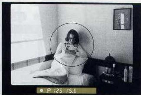
2. Sollicitez légèrement le déclencheur et vérifiez la vitesse et l'ouverture dans le viseur.
