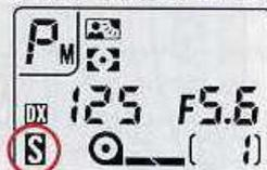
Si **S** est choisi comme mode d'entraînement du film, en pressant franchement le déclencheur, vous prenez une photo et le film s'entraîne automatiquement à la vue suivante.
