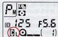
La prise de vue s'effectue en continu tant que le déclencheur est pressé. Avec ce mode d'entraînement, il est possible de sélectionner deux cadences, une rapide et une normale. La cadence rapide **CH** permet environ 2 vues par seconde et la normale **CL** environ 1,2 vue par seconde, ceci avec une pile neuve utilisée à température normale, et avec une vitesse supérieure au 1/125 sec. Plus la vitesse d'obturation est lente, plus la cadence du moteur se ralentit.
