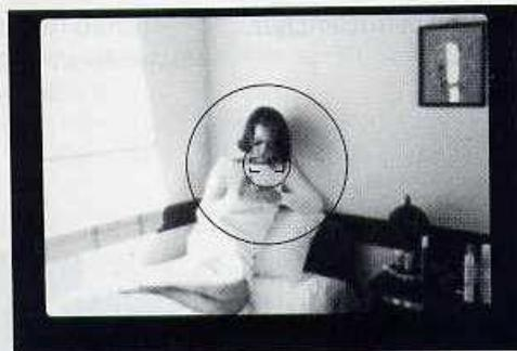
1. Centrez le sujet principal dans le cercle de diam. 12mm du viseur en mesure centrée ou dans le cercle de diam. 3,5mm en mesure ponctuelle, au besoin rapprochez-vous.
