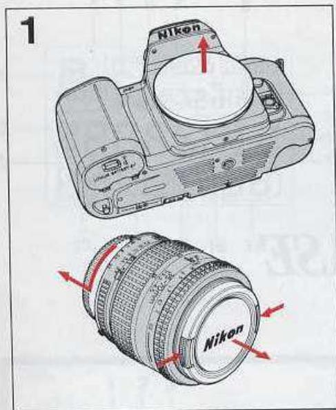
Enlevez le bouchon du boîtier et les bouchons avant et arrière de l'objectif.
