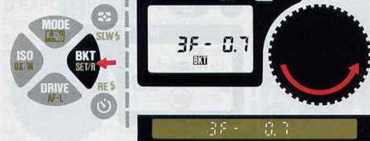
3. Tout en maintenant la commande BKT, tournez le sélecteur multi-fonction jusqu'à ce que la combinaison souhaitée "nombre de vues/valeur de correction" apparaisse sur l'écran de contrôle et dans le viseur. Par exemple, pour prendre trois vues avec une correction de 0,7IL, programmez sur 3F-0,7.
