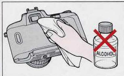
7. Nettoyez l'oculaire du viseur et l'écran de contrôle avec un chiffon doux et propre. N'utilisez pas de nettoyants liquides.
