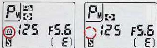
Le F-601 est doté de deux systèmes de réglage pour la sensibilité du film: un réglage automatique pour les films codés DX et un réglage manuel.
