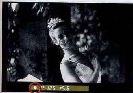
2. Contrôlez la présence de l'indicateur de mise au point correcte ● dans le viseur.
