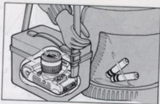
2. Par grand froid, la capacité des piles diminue considérablement. Si vous voulez utiliser l'appareil dans ces circonstances, mettez des piles fraîches et protégez, dans la mesure du possible, l'appareil du froid.
