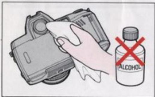
7. Nettoyez l'oculaire du viseur avec un chiffon propre et doux, non pelucheux. N'utilisez pas d'alcool.
