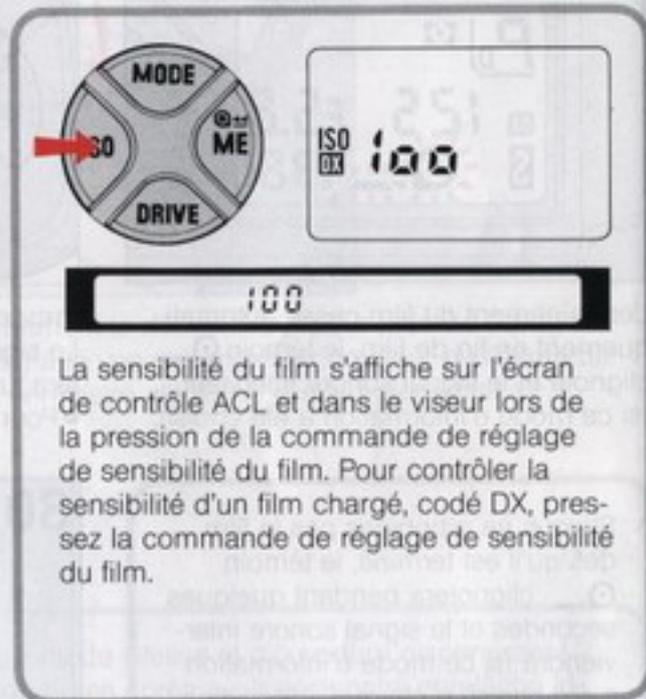
La sensibilité du film s'affiche sur l'écran de contrôle ACL et dans le viseur lors de la pression de la commande de réglage de sensibilité du film. Pour contrôler la sensibilité d'un film chargé, codé DX, pressez la commande de réglage de sensibilité du film.
