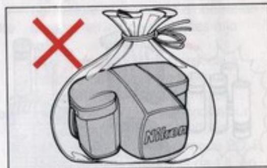
appareil dans un sac en vinyle, avec un dessiccant spécial, pour le protéger de la poussière, de l'humidité et du sel. Cependant, le rangement de l'étui en cuir dans le sac vinyle risque de l'endommager.
