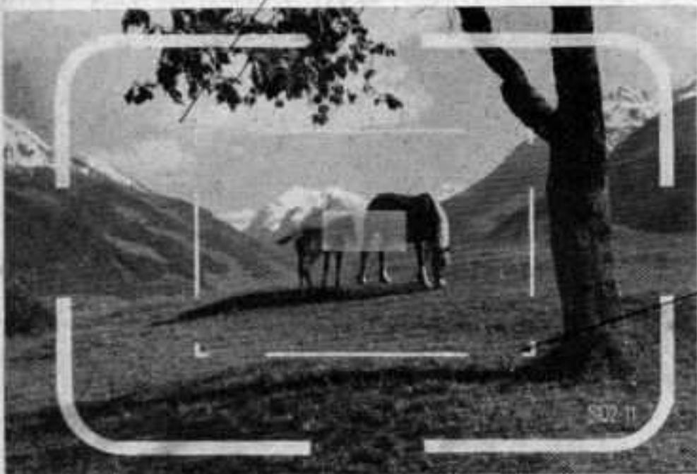
Champ dans le viseur pour un objectif de 90 mm. Le champ des objectifs de longue focale est indiqué par un cadre lumineux supplémentaire à l'intérieur du grand cadre visible en permanence.
