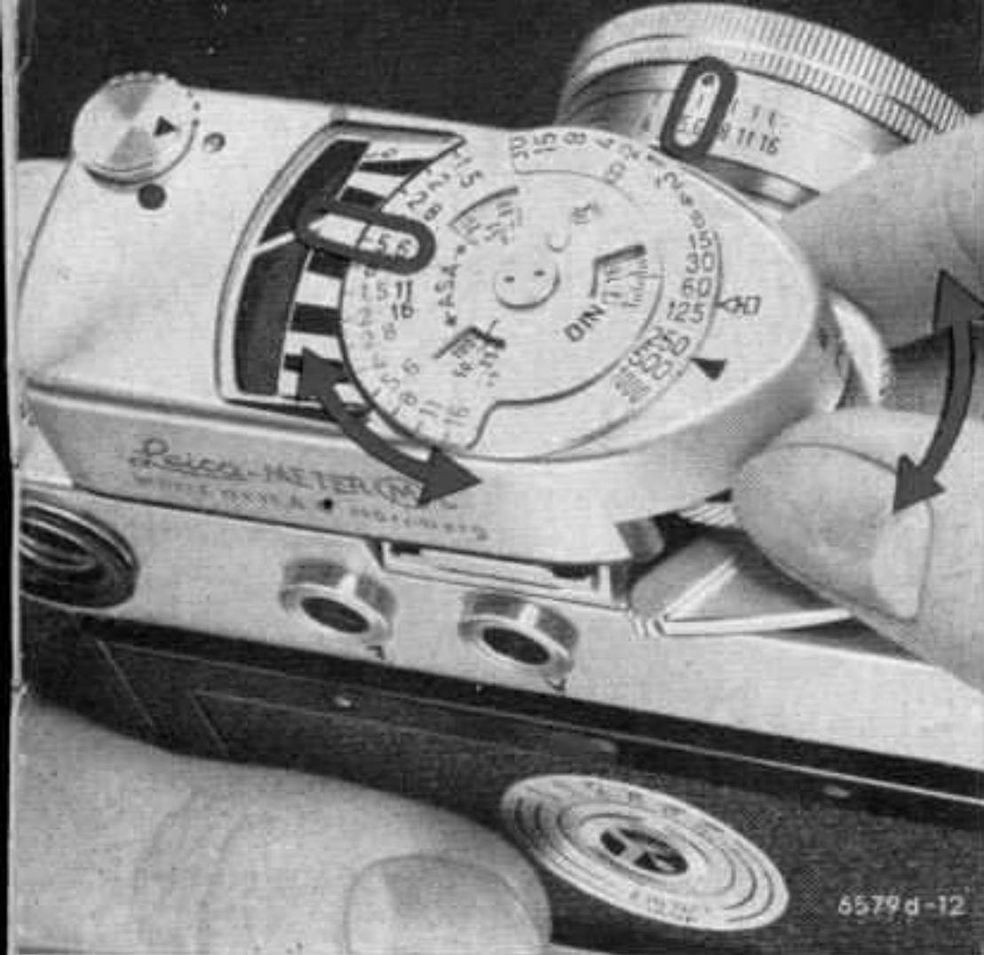
Le LEICAMETER "MC" doit être réglé d'après la rapidité du film contenu dans l'appareil. Il comporte deux gammes de mesure directement sur l'instrument. Une troisième – pour les très mauvaises conditions d'éclairage – nécessite l'adjonction d'une cellule supplémentaire (voir la notice spéciale d'utilisation).
