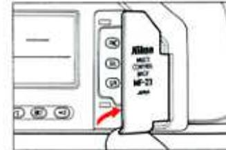
Ouvrir le couvercle du tableau des commandes. Pour activer l'ACL, appuyer sur n'importe quel sélecteur. L'affichage restera activé pendant environ 8 secondes (environ 16 secondes lorsque la mesure d'exposition de l'appareil photo est activée).
