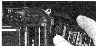
1. Retirez le dos standard de l'appareil, en pressant le verrou de l'axe du dos.
