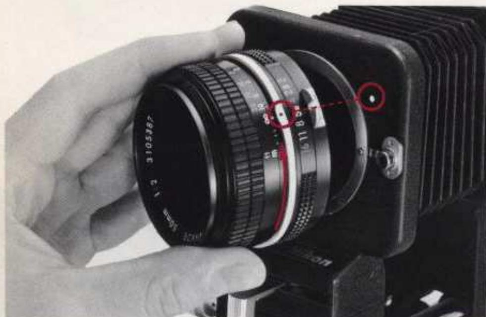
Placer l'objectif sur la monture baïonnette du cadre porte-objectif, en prenant soin d'aligner le point noir de l'objectif avec le repère blanc du cadre porte-objectif; puis tourner l'objectif dans le sens horaire inversé jusqu'au déclic.
