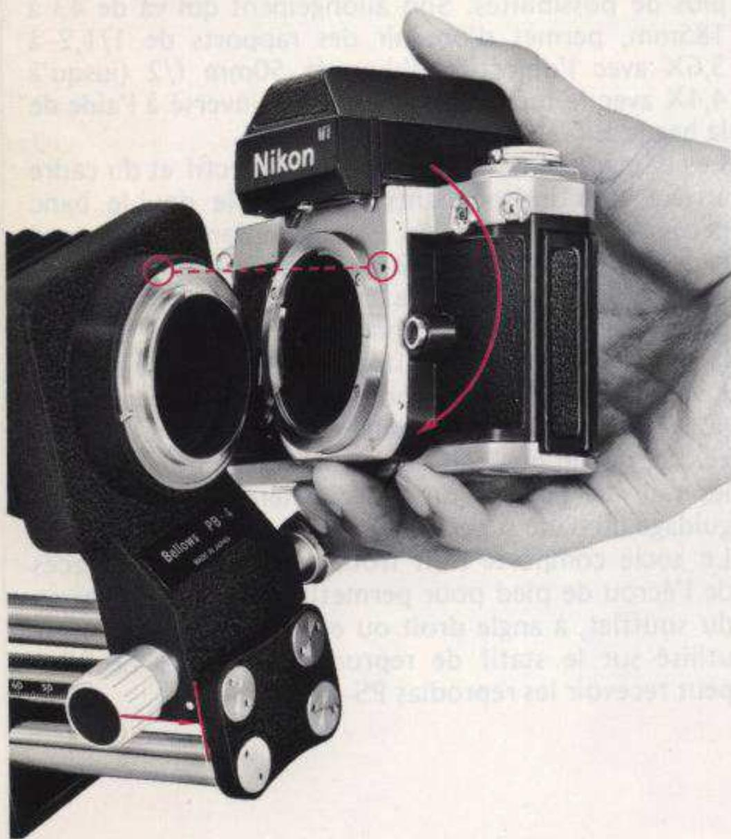
Desserrer la molette de verrouillage du cadre arrière et ramener ce dernier en butée contre le socle arrière. Monter le boîtier. Engager sa monture baïonnette dans la monture du PB-4 en prenant soin d'aligner le repère rouge du cadre arrière avec le point noir du boîtier. Tourner dans le sens horaire inversé jusqu'au déclic.
